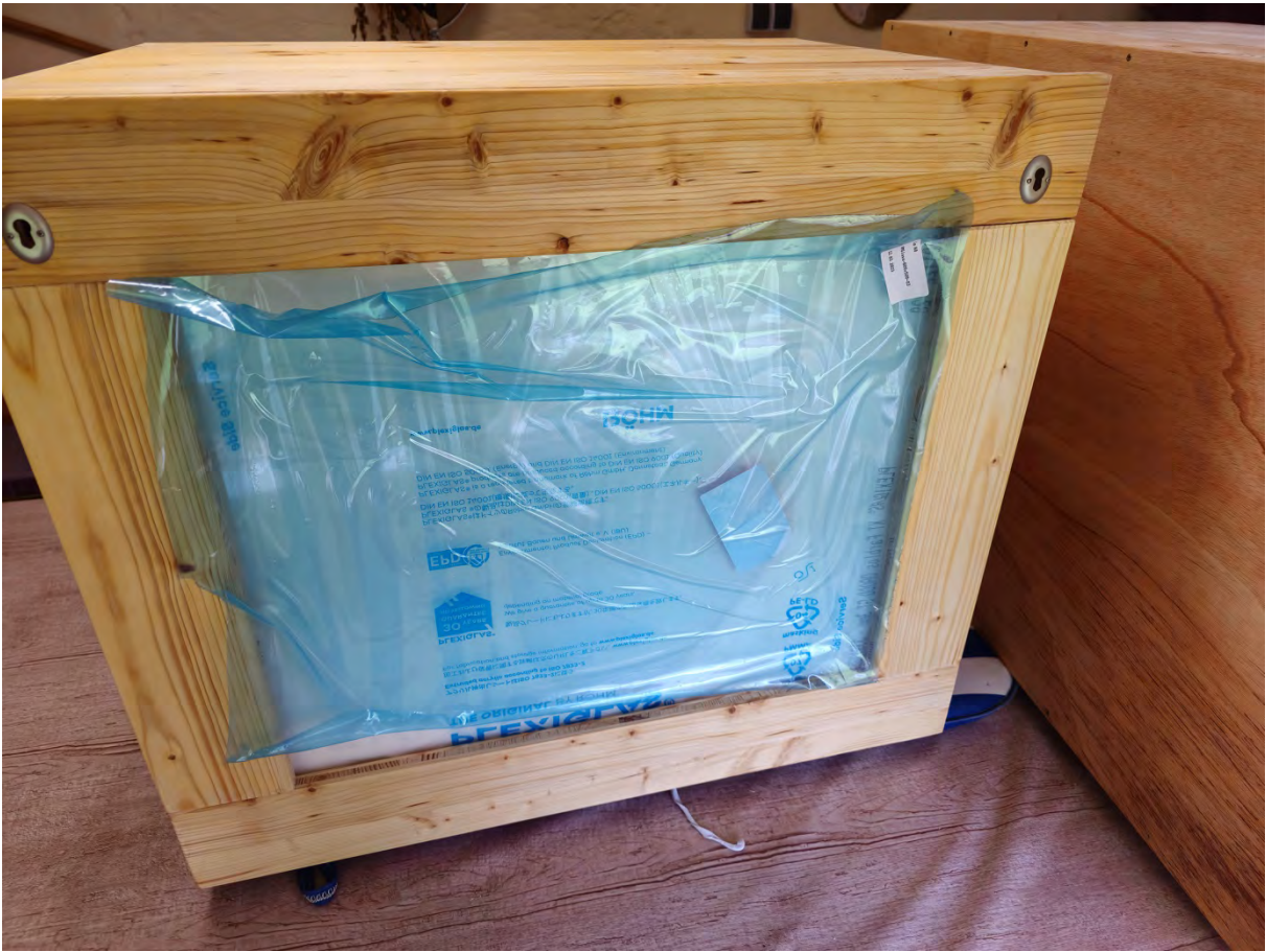
Einsetzen der Plexiglasscheiben in den Krippenkasten.
